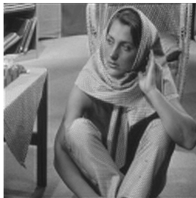
Рис. 5. Тестовое изображение “Барбара”, восстановленное с использованием оптимизированных вейвлет-фильтров по многоуровневой схеме (брр = 0.48 бит/пиксел, НСКО = 18.23 дБ)
